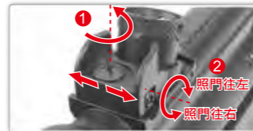
鬆開底座螺絲後使用螺絲起子調整照門風偏。
